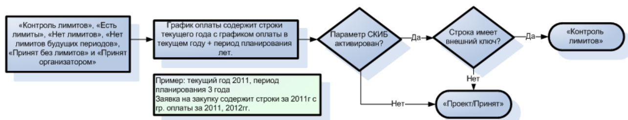
Рисунок 10 – Схема перехода на статусы при проверке наличия внешнего ключа у сметы при активированном параметре «Связь с СКИБ»
